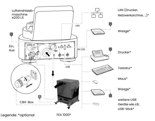
Abbildung 11 Aufbau und Anschlüsse mit Industriesauger FEX 1000
