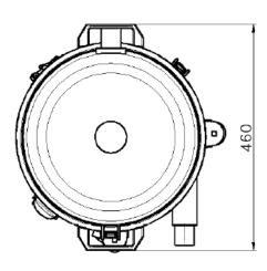
Abbildung 7 Hauptabmessungen des Vorabscheiders
