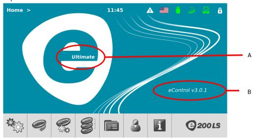
Auf dem Home-Screen (siehe Abbildung oben) kann abgelesen werden, welche Lizenz das Gerät aktuell verwendet (**A**, siehe Abbildung oben) und welche Version der Software "eControl" installiert ist (**B**, siehe Abbildung oben).
