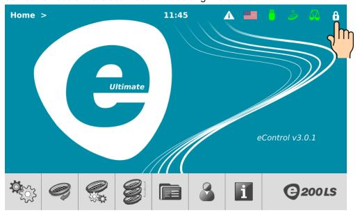
Es öffnet sich ein Eingabefenster, in dem zuerst der Benutzername und danach das korrekte Passwort eingegeben werden muss. Beide Eingaben werden durch Drücken des OK-Buttons auf der Tastatur bestätigt.
