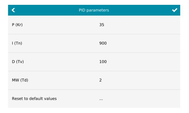
Je nach verwendetem Sauger, Frequenzumrichter oder Regelklappe müssen die PID-Parameter angepasst werden. Folgende Tabelle beinhaltet Empfehlungen.
