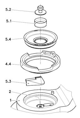
Abbildung 14 Aufbau der Mikrosiebe
