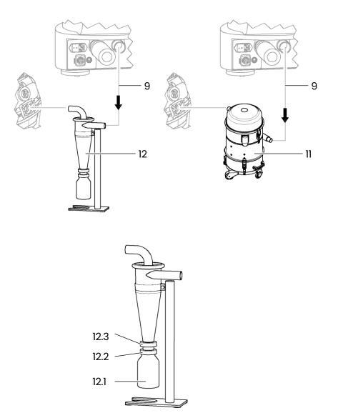
Abbildung 24 Ersatzteilzeichnung Zyklon GAZ 120 & Vorabscheider D360
