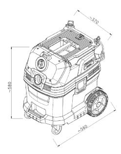
Abbildung 5 Hauptabmessungen des Staubsaugers
