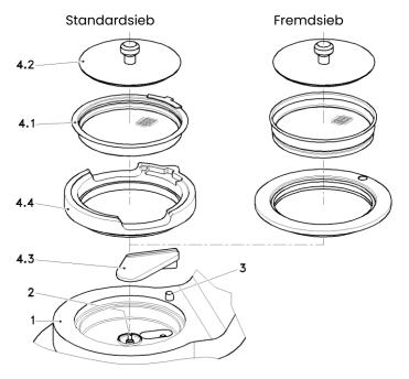
Abbildung 13 Aufbau mit Adapterring
