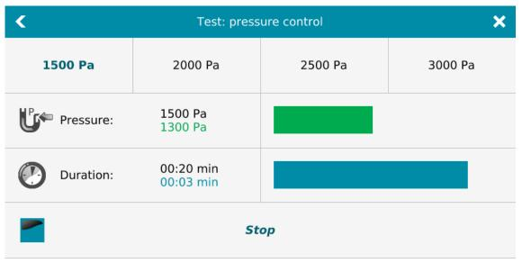
Hier können Sie bis zu vier Unterdruck-Referenzwert-Messungen durchgeführt werden. Drücken Sie hierfür jeweils auf einen der in der obersten Zeile angegebenen Werte und der Sauger wird für 20 Sekunden so geregelt, dass die Druckanzeige dem ausgewählten Wert entspricht.
