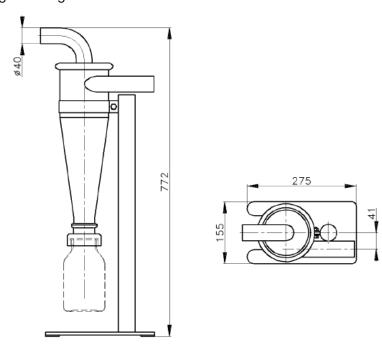
Abbildung 8 Hauptabmessungen des Zyklons GAZ 120
