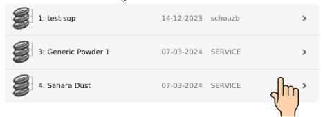
Hier werden die vorkonfigurierten Prüfsiebe mit deren festen Parametern aufgelistet. Die Prüfsiebe sind von fein- bis grobmaschig aufsteigend sortiert.
