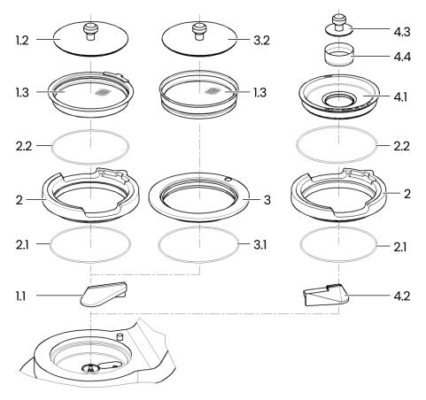
Abbildung 22 Ersatzteilzeichnung Siebaufsätze
