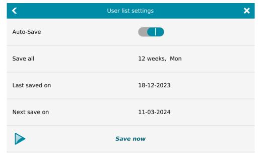
Hier können Sie die automatische Generierung der Benutzerliste im PDF-Format ein- und ausschalten. Wenn eingeschaltet, muss das Zeitintervall der automatischen Ausgabe konfiguriert werden.
