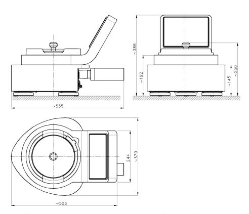
Abbildung 2 Hauptabmessungen der Luftstrahlsiebemaschine
