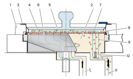
Abbildung 1 Funktionsskizze der Luftstrahlsiebmaschine
